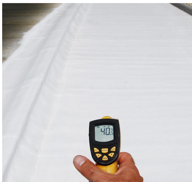
Température du toit après application de la membrane liquide
